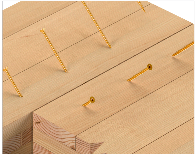
ESCRFTC i CLT gulvelement stødsamling.
