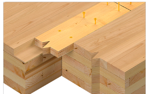
SWC-skruer monteret i en CLT-laskepladesamling.
