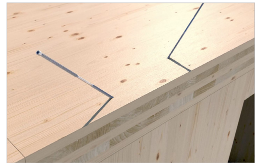
SWD skrå installation af CLT gulv-til-væg samling
