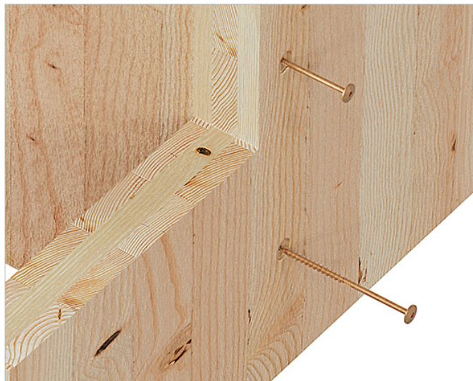
SWW skruer monteret i en T-forbindelse mellem to CLT vægge.
