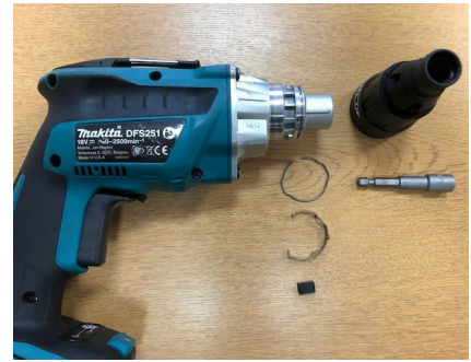
Vær sikker på at fjerne alle metal ringe og gummidele.
