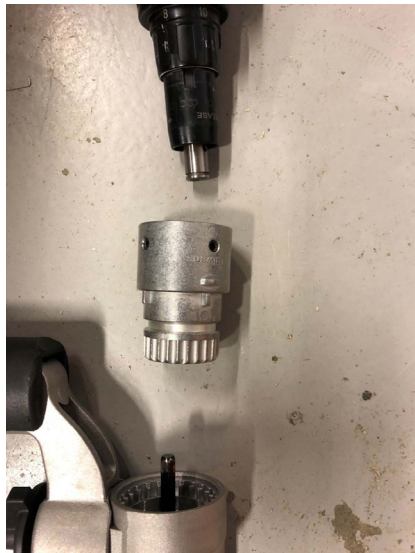
Adapter sættes på spidsen og skubbes helt på plads og pinolskruer tilspændes.
