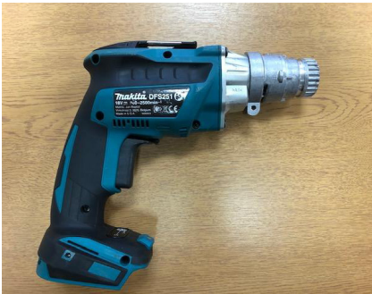
Monter QD adapter så den sidder helt tilbage mod maskinen.
