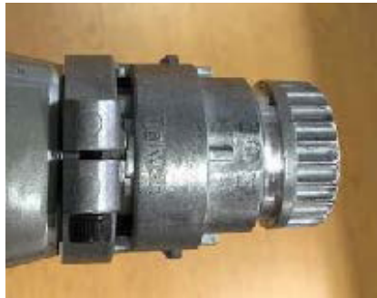
Spænd skruen for at fastgøre adapteren.
