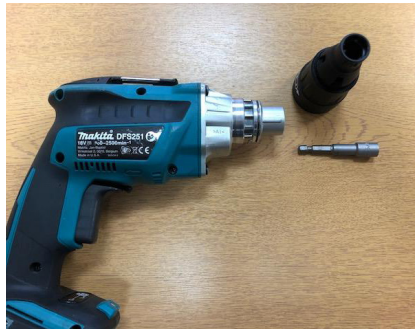
Fjern dybdestop og bitholder.
